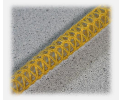
Ummantlung von Einlagen Warpknitted around the inlay
