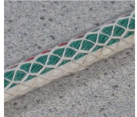
Ummantelung von Einlagen Warpknitted around the inlay
