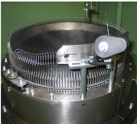
Fadenführer Yarn feeder
