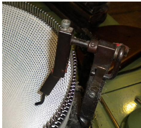
Laufmaschenwächter Drop stitch stop motion
