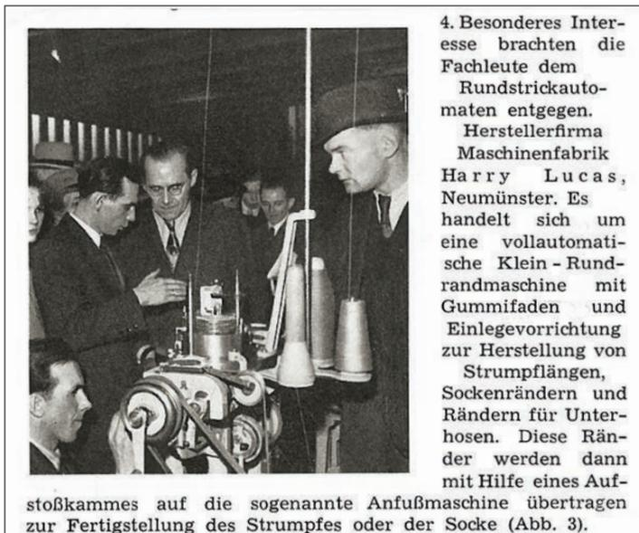
4. Besonderes Interesse brachten die Fachleute dem Rundstrickautomaten entgegen. Herstellerfirma Maschinenfabrik Harry Lucas, Neumünster. Es handelt sich um eine vollautomatische Klein-Rundrandmaschine mit Gummifaden und Einlegevorrichtung zur Herstellung von Strumpflängen, Sockenrändern und Rändern für Unterhosen. Diese Ränder werden dann mit Hilfe eines Aufstoßkammes auf die sogenannte Anfußmaschine übertragen zur Fertigstellung des Strumpfes oder der Socke (Abb. 3).
