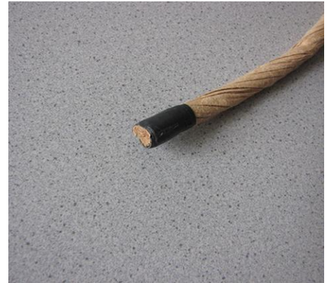
Abkleben/schneiden/Dichtung Taping / cutting / for seals
