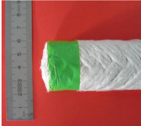
Abkleben/schneiden/Dichtung Taping / cutting / for seals
